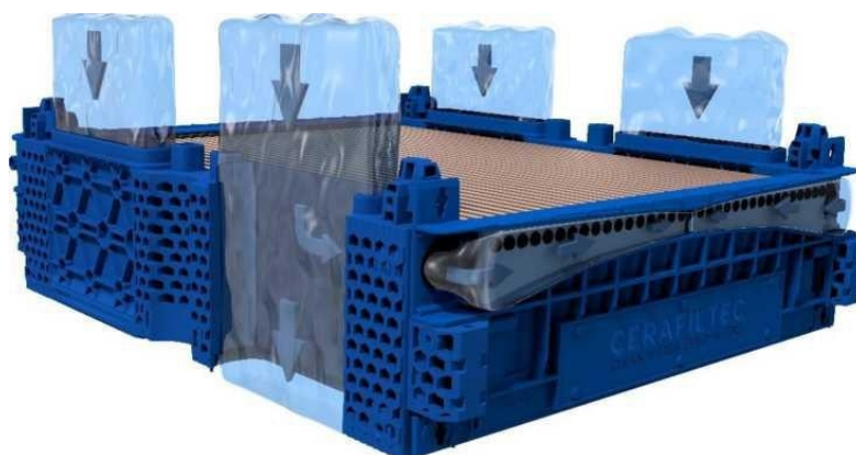
图4-18 反冲洗水流流向
