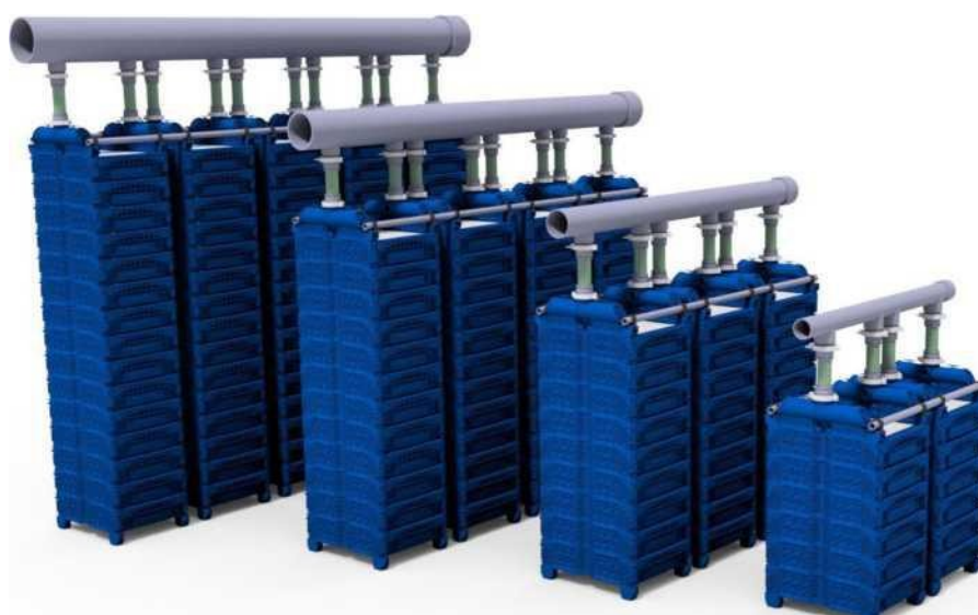
图4-13 不同的膜塔配置
