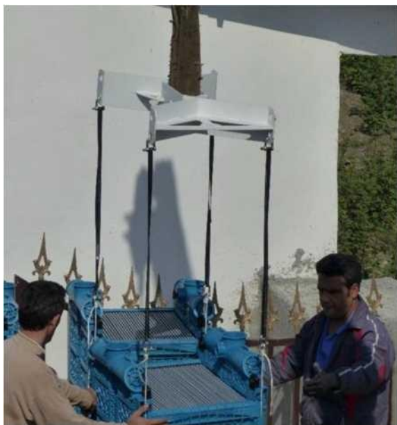
图7-1 用起重工具提升塔，吊绳环必须精确垂直
